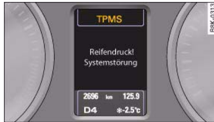
Fig. 28 Display: System fault ("Systemstörung")
