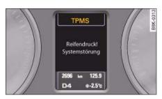
Fig. 28 Display: System fault ("Systemstörung")
